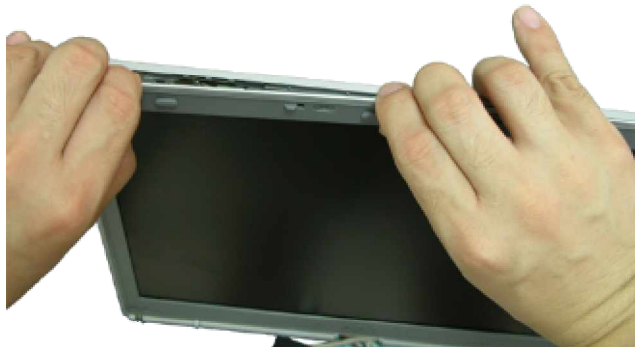
Fig. 23 Removing the LCD Bezel
