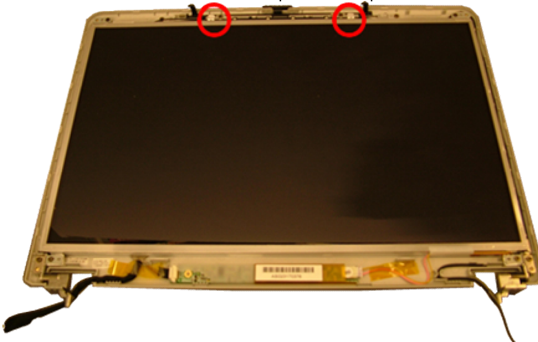
Fig. 26 The wireless LAN antenna.
